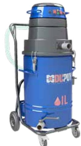
Vypúšťací nástavec (dodáva sa s voliteľným čerpadlom)
